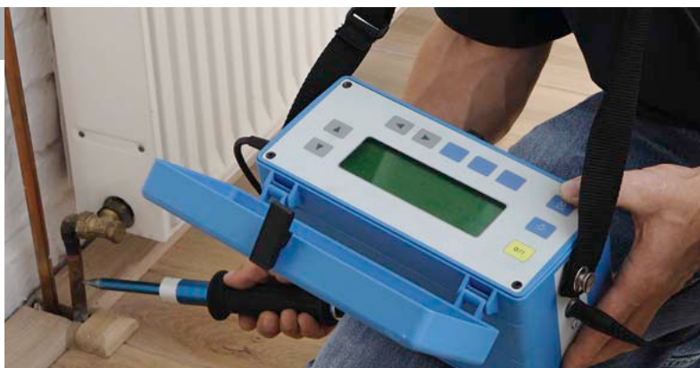
Elektroakustische Leckageortung: Hochleistungs-Mikrofone im Einsatz
