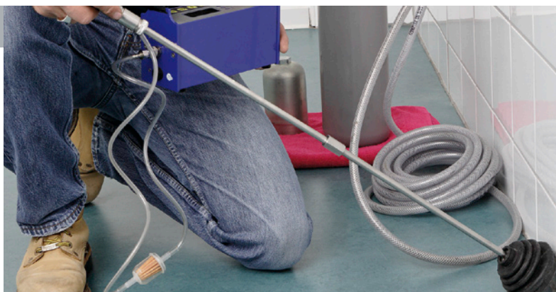
Gasetektion: das Messgerät „riecht“ die Leckage
