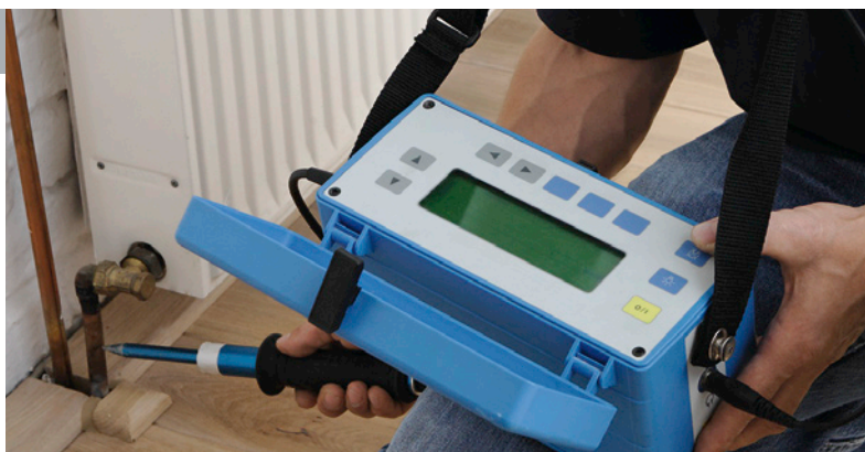
Elektroakustische Leckageortung: Hochleistungs-Mikrofone im Einsatz
